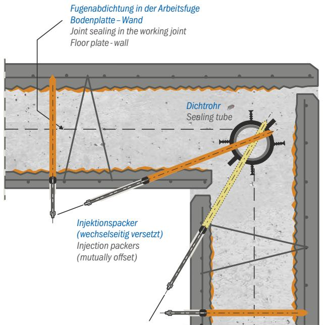
Nachträgliche Abdichtung einer Elementwandecke mit Dichtrohr durch Injektion
