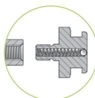
**\*423- HD-Flachkopfnippel mit Dichtkonus (loose beigelegt)**
