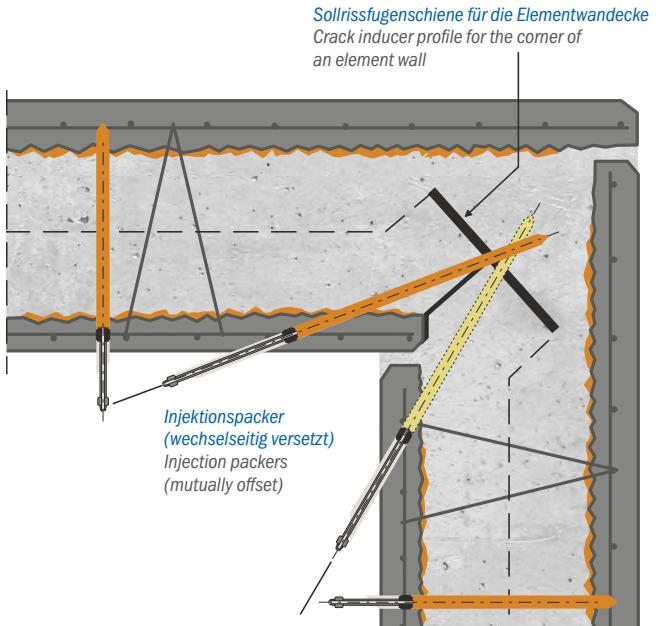
Nachträgliche Abdichtung einer Elementwandecke mit einer Sollrissfugenschiene
