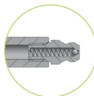
**\*404- HD-Kegelnippel mit Dichtkonus (vormontiert)**
