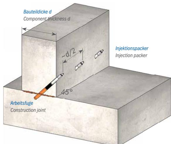
**Verpressung einer Arbeitsfuge zwischen Bodenplatte und Wand**
