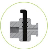
**Flachkopfnippel mit Querschieber, freier Durchgang**
